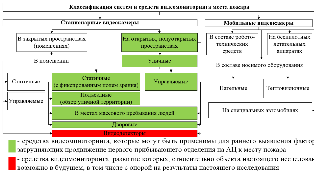
Рисунок 3 – Классификация систем и средств видеомониторинга места пожара
